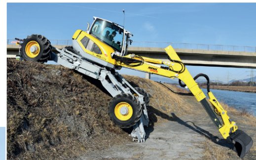
Die Spezialität vom M545x Arbeiten bis 45° Falllinie oder 30° Schichtlinie
