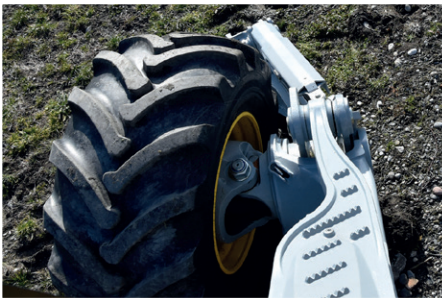
Bergstütze automatisch nicht im Arbeitsbereich
